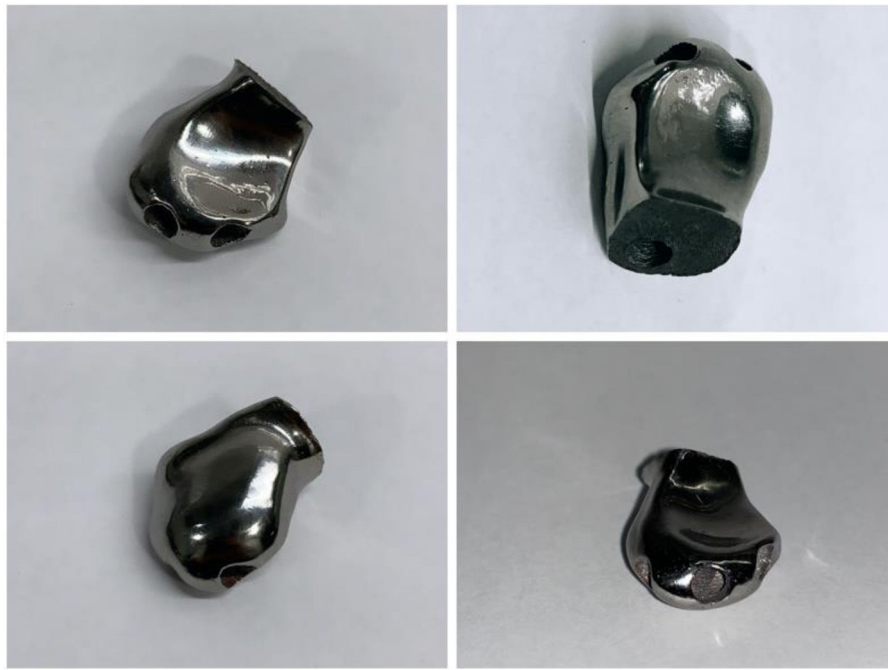
Figura 2 Imágenes del implante fabricado en titanio. En él se pueden ver las carillas articulares, la carilla plana distal, el canal ciego a lo largo de su eje y los orificios proximales para el paso de la plastia.
