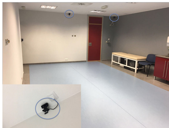
Figura 1 Área de captura de movimiento donde se realizó el estudio. Señaladas con círculos las cámaras PS Eye. El rectángulo inferior izquierdo muestra una de las cámaras en detalle.
