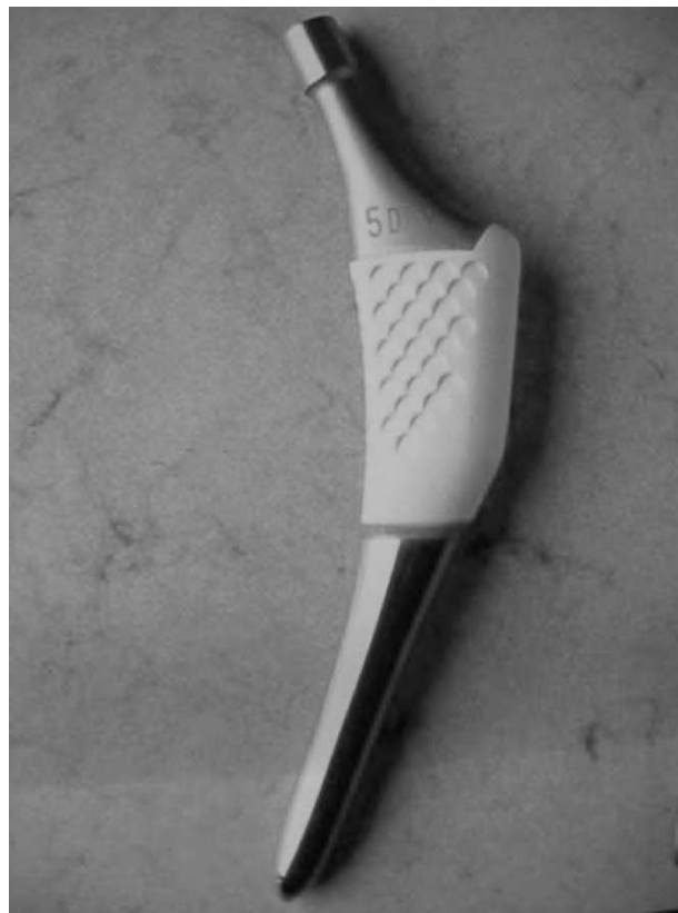
Figura 1. Vástago ABG-II® que muestra la zona metafisaria con recubrimiento de hidroxiapatita y la cola, pulida, delgada y breve.
