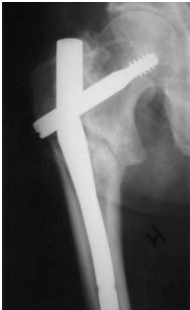
Figura 5. Rotura por fatiga de un clavo Gamma a nivel del orificio de entrada del tornillo cervical a los 7 meses de su implantación, asociado a pseudoartrosis de la fractura.
