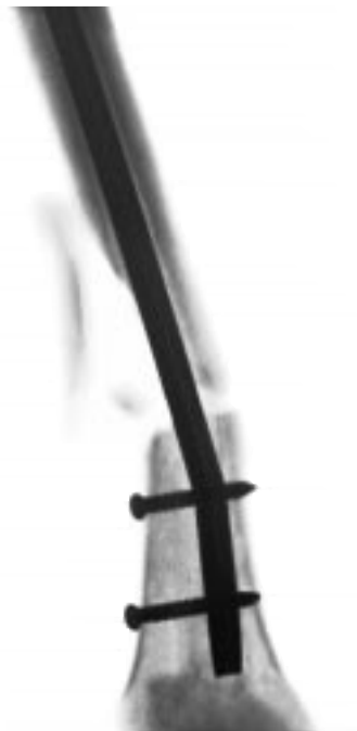
Figura 7. Rotura del clavo a nivel del agujero del tornillo de bloqueo. Solicitación combinada de compresión axial y fuerzas predominantes de flexión, transmitidas por el largo brazo de palanca que representa el clavo en situación intramedular.
