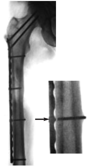
Figura 10. Fractura por fatiga de un tornillo de titanio, después de consolidar la fractura (1 año), en una osteosíntesis realizada con el mínimo número de tornillos. La diferente elasticidad entre el hueso y el titanio concentra las solicitaciones, traducidas en cizallamiento a nivel del cuello del tornillo.
