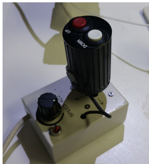
Figura 5 Mando para micromanipulador de la aguja de sujeción del ovocito (movimiento grueso y fino). Fotografía del autor.
