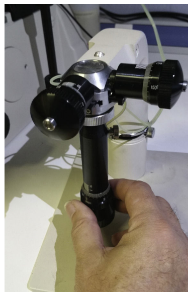
Figura 6 Mando para micromanipulador de la aguja de microinyección del espermatozoide (movimiento grueso y fino). Fotografía del autor.
