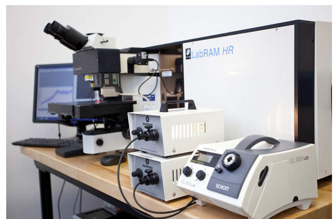
Figura 4 Microscopio Raman de alto rendimiento Horiba LabRAM HR. Tomada de Flickr.
