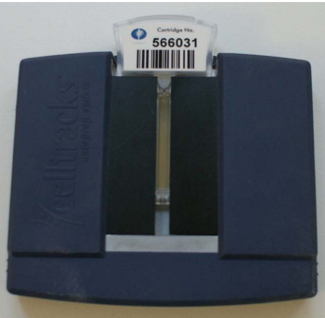
Figura 2 Cartucho y dispositivo de presentación celular MagNest®.
