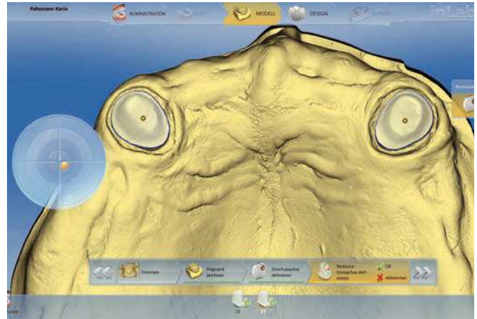
Fig. 18. Para la determinación del eje de inserción común necesario, posteriormente se agrupan las coronas individuales en una unidad conjunta.
