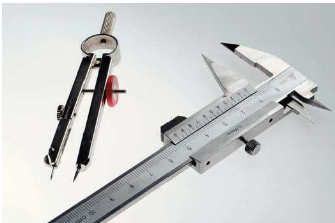
Fig. 19. El compás de puntas y el pie de rey son instrumentos auxiliares que se han convertido en imprescindibles en una restauración.
