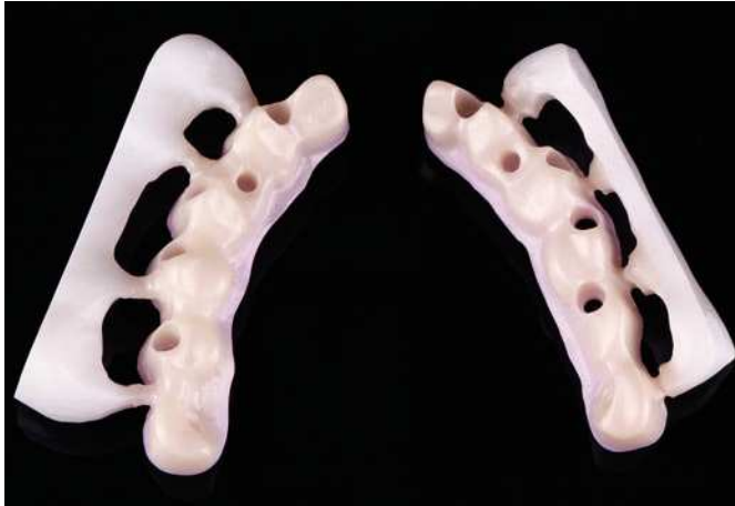
Fig. 12. Ambas barras se trasladan a zirconia Prettau (Zirkonzahn) mediante la técnica de fresado copiado (Zirkograph 025 ECO).
