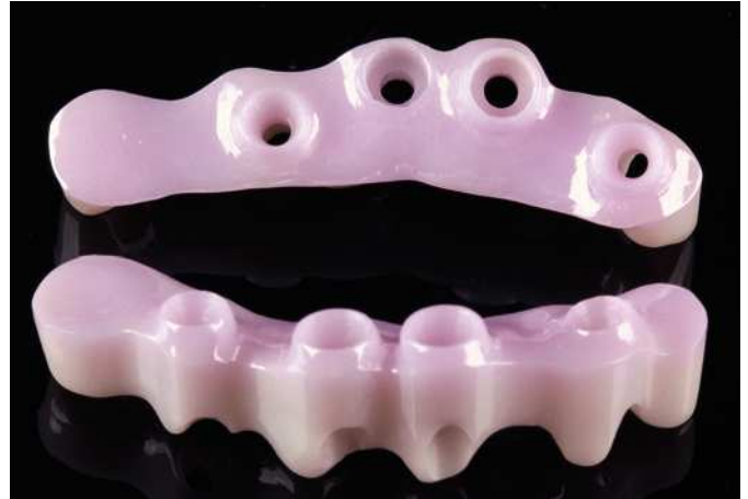
Fig. 13. Las barras tras la sinterización. Antes de la sinterización se coloraron las barras en la porción gingival aplicando la técnica de pincel (Colour Liquid Prettau Set, Zirkonzahn).
