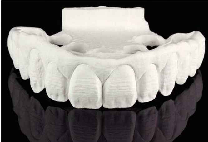
Fig. 27. La pieza secundaria en zirconia Prettau antes del proceso de sinterización definitivo y tras el fresado copiador en el Zirkograph 025 ECO.
