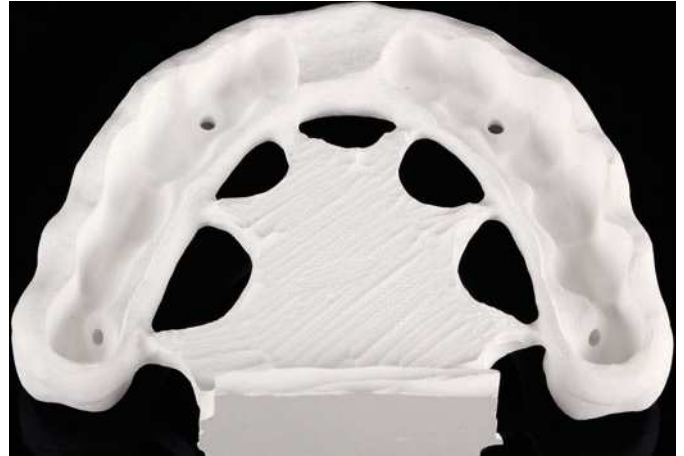
Fig. 28. La pieza secundaria tras el fresado copiador. Vista desde apical antes de la sinterización.
