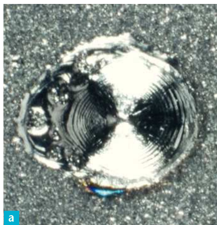
Fig. 2. Puntos de soldadura a con baño de argón adecuado y b totalmente insuficiente o sin baño de argón. Mientras que la soldadura a permite emitir un pronóstico a largo plazo favorable, una soldadura con la configuración de argón incorrecta se romperá probablemente muy pronto y bajo la acción de fuerzas muy bajas.
