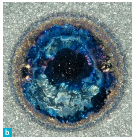
Fig. 2. Puntos de soldadura a con baño de argón adecuado y b totalmente insuficiente o sin baño de argón. Mientras que la soldadura a permite emitir un pronóstico a largo plazo favorable, una soldadura con la configuración de argón incorrecta se romperá probablemente muy pronto y bajo la acción de fuerzas muy bajas.
