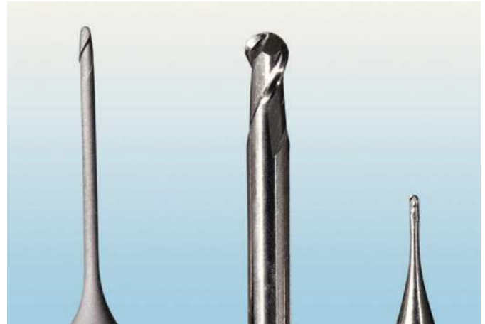
Fig. 9. Se muestran, de izquierda a derecha: fresa para bordes incisales D 0,65, fresa desbastadora D 2,5 y microfresa D 0,5.
