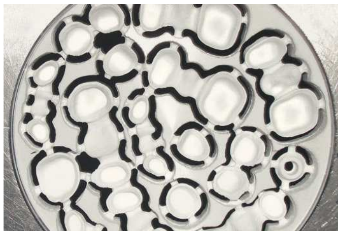
Fig. 2. Las construcciones de ZrO_2 fresadas. En este caso no es posible el corte y el tratamiento con láser, como en las estructuras metálicas. El ajuste debe ser correcto desde el principio.
