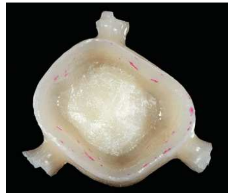
Figs. 11 y 12. La zona del chamfer constituye a menudo el punto neurálgico en cuanto al ajuste. El examen crítico bajo el microscopio revela en muchos fresados pequeños defectos en el chamfer, que pueden eliminarse mediante la microfresa con un diámetro de 0,5 mm.
