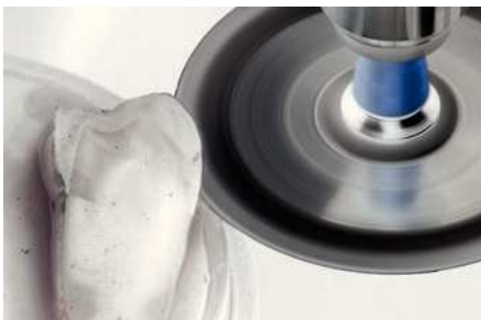
Fig. 4. Para el corte puede utilizarse un disco diamantado estándar de 0,5 mm.
