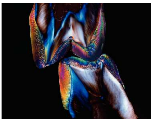
Figs. 8 y 9. Cuando los ejes de polarización de ambos filtros se hallan en ángulo recto entre sí, se bloquea totalmente la luz. Sin embargo, la dirección de oscilación de la luz que atraviesa el objeto ha sido modificada, de modo que no es bloqueada por el filtro de polarización situado delante de la cámara. El resultado es que el objeto aparece en su color natural ante un fondo blanco, gris o negro, dependiendo del giro del analizador (filtro).
