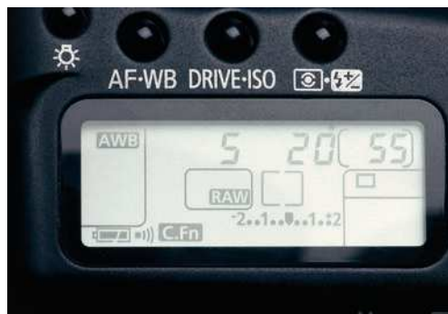
Fig. 12. La preselección del diafragma debería ajustarse a f: 20. En el modo AV se determina automáticamente el tiempo de exposición.
