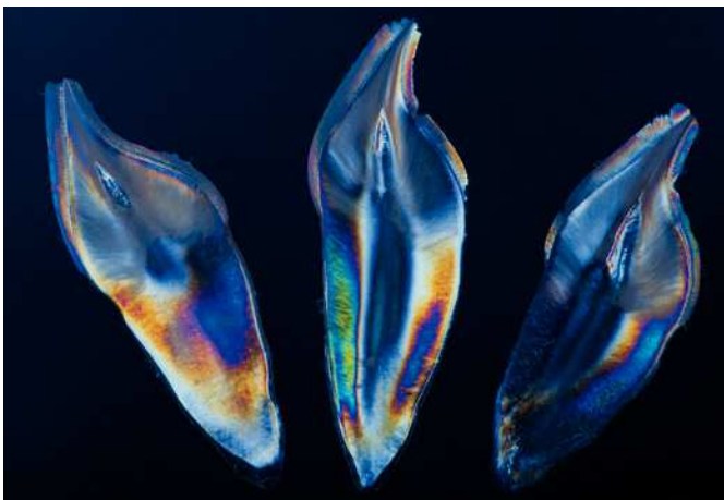
Figs. 24 y 25. La interferencia de las secciones dentales puede desplazarse mediante la incorporación de un segundo filtro de polarización circular en ambos extremos del polariscopio. Esto resulta en un desplazamiento de un escalón cromático (por ejemplo del color básico azul al color básico rojo).
