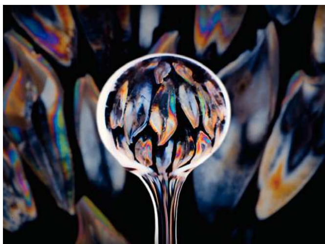
Figs. 29 y 30. Como alternativa práctica, una pantalla LCD puede convertirse en un polarizador de gran tamaño, que hace innecesario el uso de un segundo filtro de polarización. El tamaño de la mayoría de pantallas LCD posibilita composiciones de imagen complejas y de gran tamaño.
