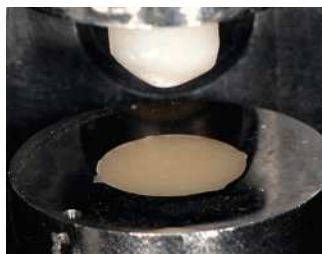
Fig. 3. Los cuerpos de ensayo, fijados en la máquina de masticación.
