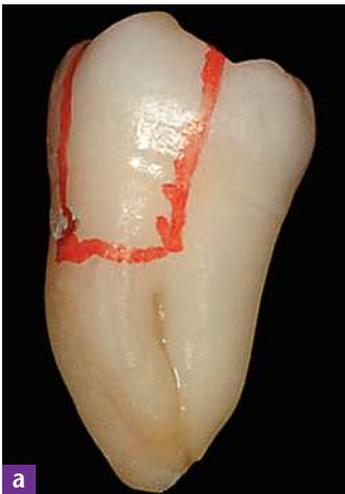
Figs. 2a a 2d. Confección de los antagonistas para las mediciones de la abrasión: a molar superior del cual se corta una cúspide mesiobucal; b la cúspide cortada con retenciones; c orientación de la posición de la cúspide en un dispositivo construido al efecto para la máquina de masticación; d antagonista ya fijado para la máquina de masticación.
