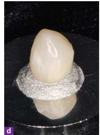
Figs. 2a a 2d. Confección de los antagonistas para las mediciones de la abrasión: a molar superior del cual se corta una cúspide mesiobucal; b la cúspide cortada con retenciones; c orientación de la posición de la cúspide en un dispositivo construido al efecto para la máquina de masticación; d antagonista ya fijado para la máquina de masticación.
