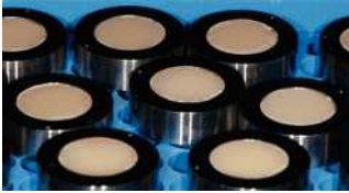
Fig. 1. Cuerpos de ensayo de resinas para prótesis provisionales para la medición de la abrasión.
