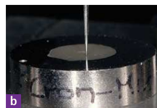
Figs. 5a y 5b. La medición de la abrasión a en el antagonista y b en la resina para prótesis provisionales.
