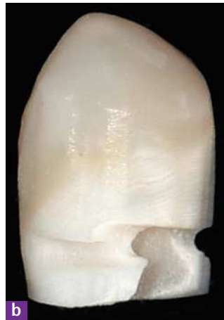
Figs. 2a a 2d. Confección de los antagonistas para las mediciones de la abrasión: a molar superior del cual se corta una cúspide mesiobucal; b la cúspide cortada con retenciones; c orientación de la posición de la cúspide en un dispositivo construido al efecto para la máquina de masticación; d antagonista ya fijado para la máquina de masticación.
