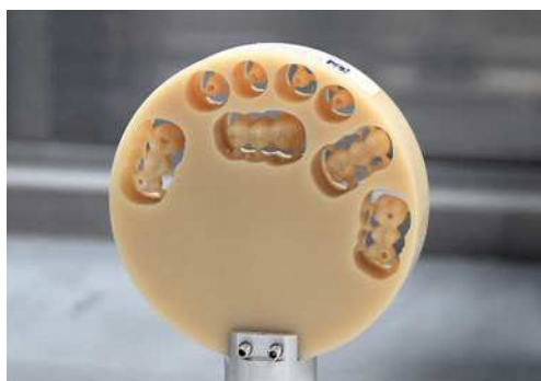
Fig. 10. La pieza bruta Orgánico-PMMA en la fresadora.
