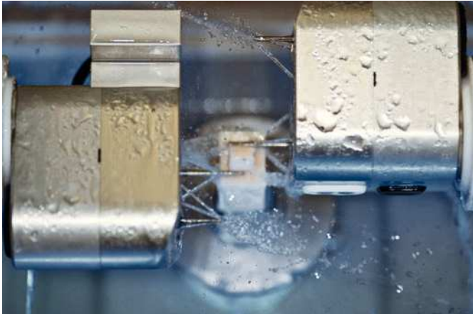
Fig. 11. El tallado de una prótesis provisional CAD/CAM.
