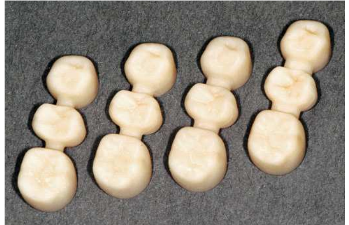
Fig. 12. Puentes artBloc-Temp de tres piezas sometidos a ensayo con distintas secciones transversales de los conectores.
