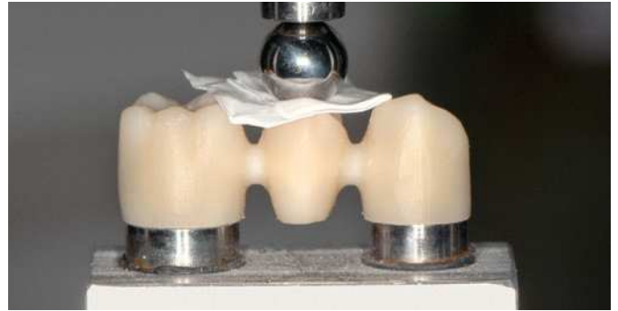
Fig. 14. La disposición del ensayo para determinar la carga de rotura de las prótesis provisionales de tres piezas.
