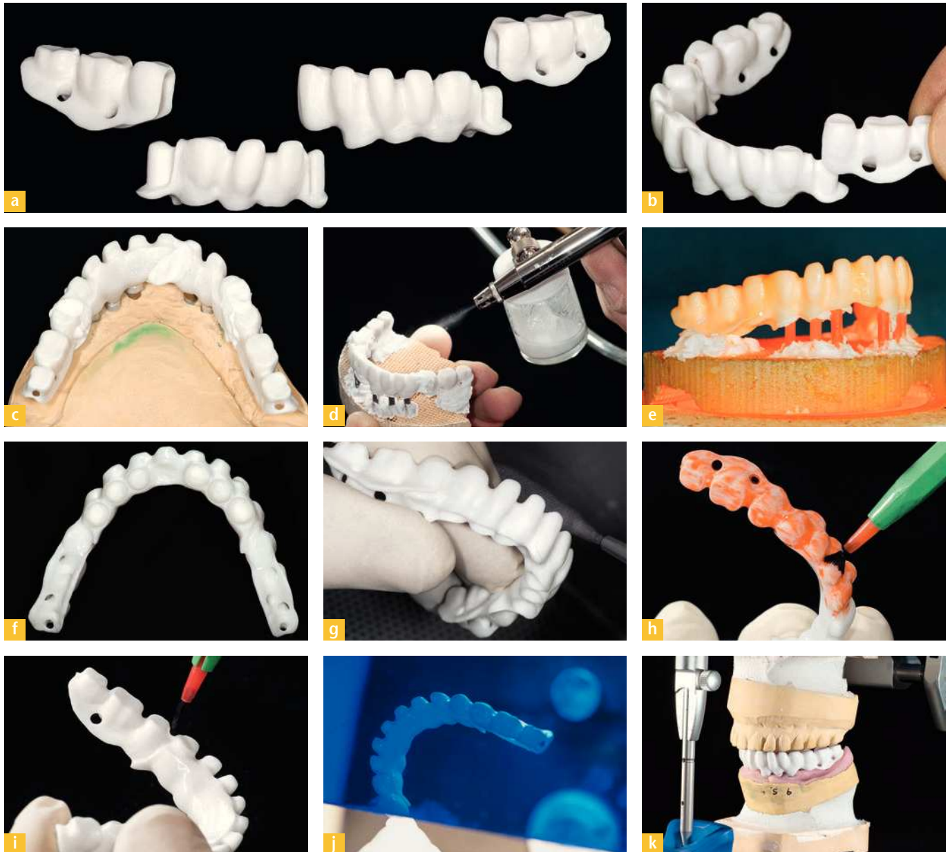
Fig. 21. a Los segmentos de estructura fresados a partir de ZrO_2 . b Todas las piezas se adaptan entre sí en ajuste suelto. c Los segmentos de la estructura sobre el modelo, fijados con masa de soldadura. d El montaje sobre el soporte de cocción; se recubre con zirconnect la superficie de la estructura. e El resultado satisfactorio de la soldadura indirecta. f La estructura desde basal, puede apreciarse la configuración convencional de la estructura. g El arenado de la superficie acondicionada. h El grabado ácido de la superficie con C-Link Etching Agent. i La silanización de la superficie con C-Link Silan. j La fotopolimerización del C-Link-Connector. k La comprobación de la estructura en el articulador.
