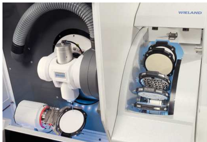
Fig. 1. La ZENOTEC T1 se des- plaza sobre siete ejes, dos de los cuales controlan la logística de discos y ejecutan el cambio de forma totalmente automática.
