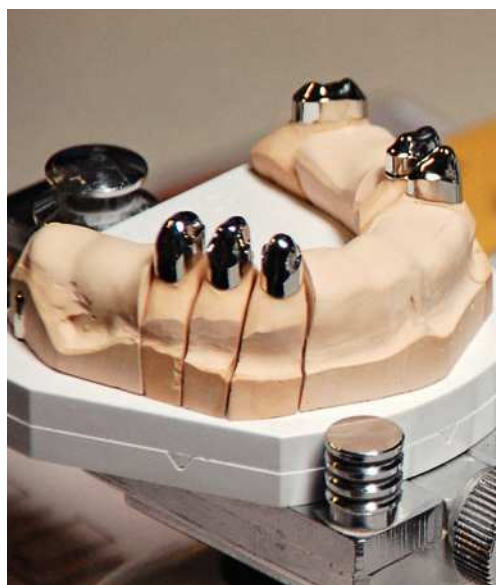
Fig. 5. Coronas telescópicas primarias de CoCr SP 2 ya pulidas.
