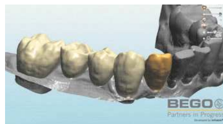
Fig. 18. La reducción digital del diseño totalmente anatómico resulta en el conjunto de datos para la corona con núcleo de dentina digital y el puente con núcleo de dentina digital.
