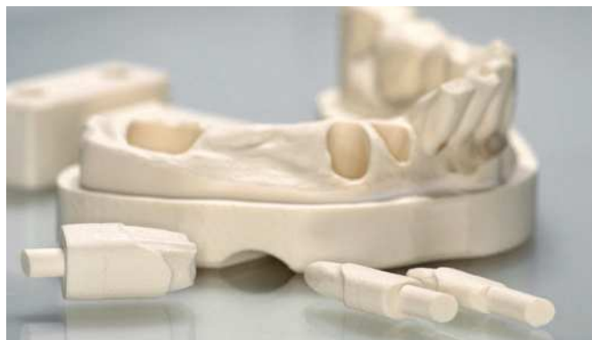
Fig. 11. El modelo maestro es confeccionado en poliuretano mediante el método de fresado CNC en las instalaciones de Straumann.
