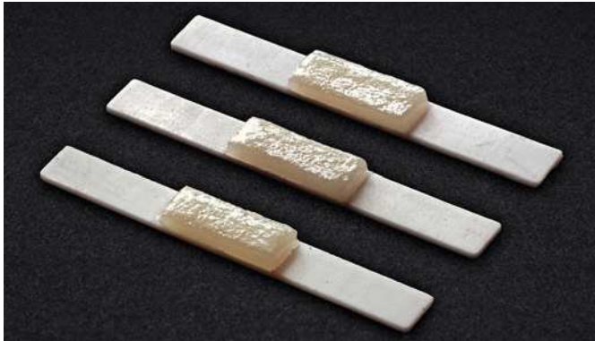
Fig. 3. Los cuerpos de ensayo para el ensayo de flexión y cizallamiento de 3 puntos según Schwickerath.
