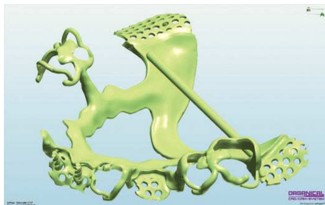
Fig. 14. El esqueleto ya diseñado, sin el modelo y con barra de soporte.
