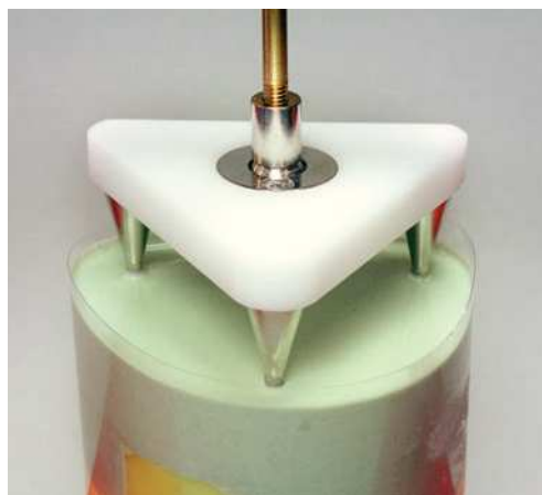
Fig. 9. El Occlutop en posición. Los casquillos de pin se encuentran firmemente insertados en el modelo de material de revestimiento.
