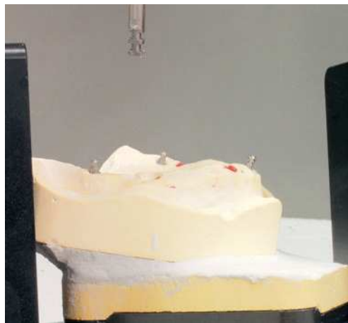
Fig. 17. La preparación del orificio de taladro para el análogo de laboratorio.
