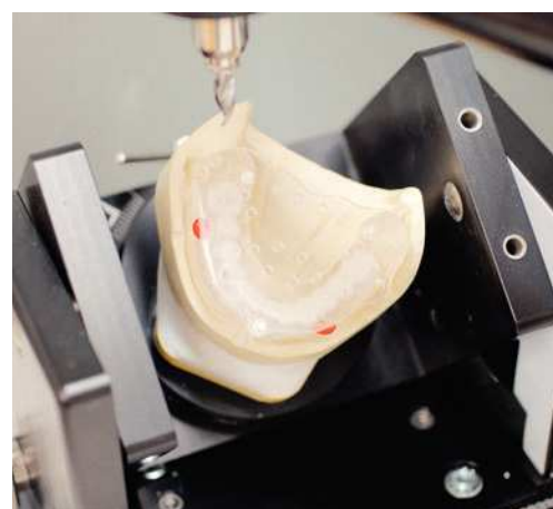
Fig. 14. Realización de un taladro con orientación angulada.
