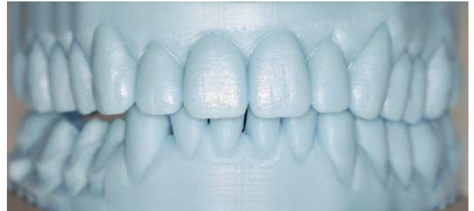
Fig. 19. El modelo confeccionado estereolitográficamente.
