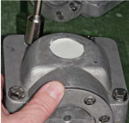
Fig. 27. La contraparte vaciada con yeso superduro en la cubeta.
