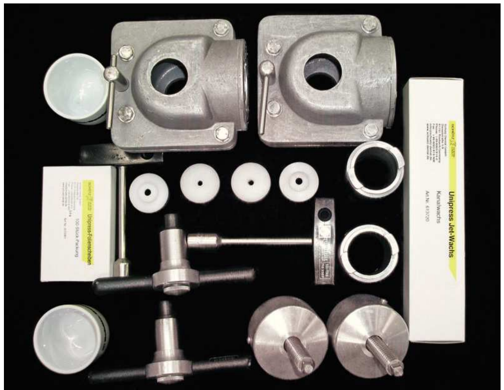
Fig. 24. El equipamiento completo para la transferencia del montaje en cera en resina.
