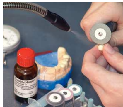
Fig. 23. La reducción y el pulido con goma de márgenes y superficies de ZrO_2 tienen lugar utilizando pulidores de goma diamantado, los cuales también se enfrían en una neblina de rociado durante el ciclo de pulido.
