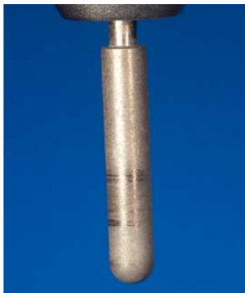
Fig. 16. Tras un breve tiempo de uso incorrecto de la fresa de diamante, la superficie de diamante se ha desprendido circularmente del vástago y el grano de diamante se ha separado del aglutinante debido a la fuerza centrífuga.
