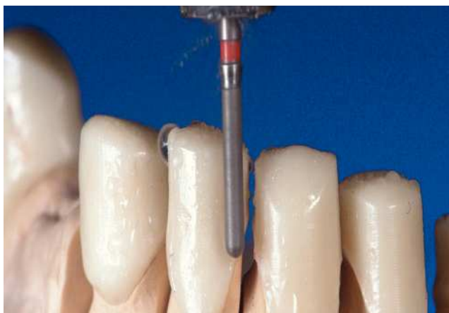
Fig. 16. Tras un breve tiempo de uso incorrecto de la fresa de diamante, la superficie de diamante se ha desprendido circularmente del vástago y el grano de diamante se ha separado del aglutinante debido a la fuerza centrífuga.
