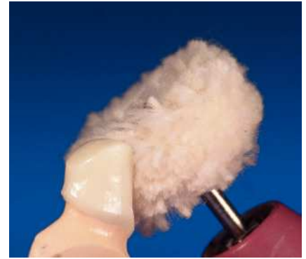
Fig. 28. El acabado superficial definitivo se lleva a cabo mediante un disco de paño de algodón que apenas contiene pasta de pulido de diamante, pero que también ha sido empapado con aceite de eucalipto. Los restos aún remanentes del pulido previo con pasta de pulido de diamante bastan para lograr un brillo intenso perfecto en la superficie de dióxido de zirconio.
