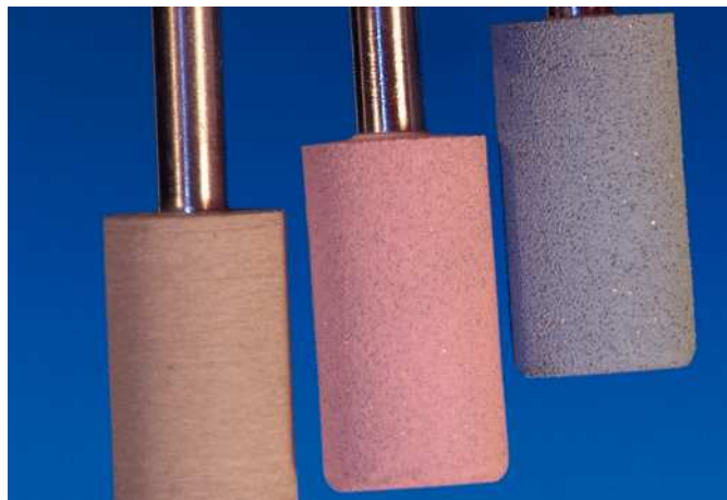
Fig. 4. Estos materiales abrasivos (gris = pulidor de goma para abrillantado intenso, rojo = grano medio, azul = grano grueso) también están indicados como pulidores de goma, a fin de trabajar superficies paralelas para la técnica de conectores en el pulido superficial final. El desgaste de estas fresas debe comprobarse y ajustarse continuamente mediante una piedra para avivar a fin de determinar que el contorno superficial sea el adecuado.
