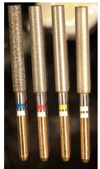
Fig. 2. Para el tratamiento superficial del ZrO_2 la firma Gebr. Brasseler, Lemgo, Alemania, ha diseñado una estrategia de mecanización adecuada para este trabajo en forma de granos determinados para los distintos materiales abrasivos diamantados. Desde grueso (azul-blanco), pasando por rojo-blanco, amarillo-blanco y blanco-blanco, la estructura de grano de los diamantes es cada vez más fina, y la estrategia de mecanización para el tratamiento manual de la superficie está adaptada en consecuencia.
