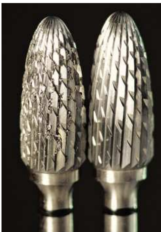
Fig. 13. Las fresas aplicadas ejerciendo presión quedan rápidamente cegadas por titanio y resultan ineficaces. Izquierda: Una fresa embotada por virutas de titanio. Derecha: Si se utiliza correctamente, la fresa se mantiene limpia.
