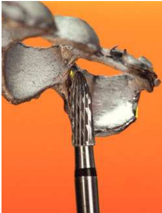
Fig. 14. Para el titanio, el truco es un acabado con un bajo número de revoluciones y prácticamente sin presión. De este modo, la abrasión con las fresas de titanio resulta blanda como la mantequilla.
