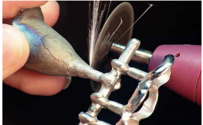
Fig. 12. La técnica de corte muestra el proceso de transformación del titanio en óxido de titanio. Cada chispa pone de manifiesto la oxidación visible con el oxígeno del aire.
