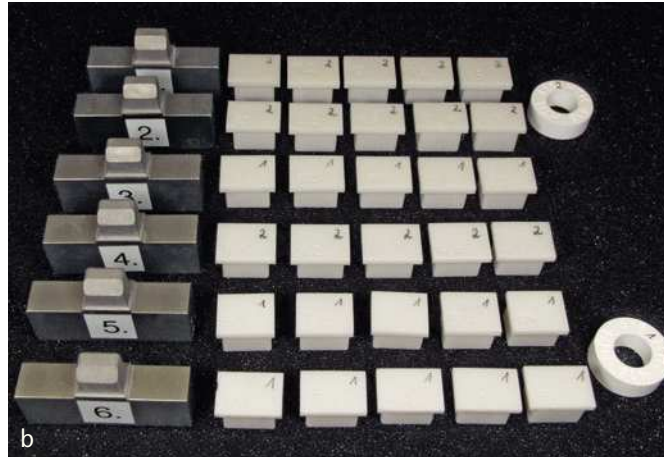
Figs. 4a y 4b. Treinta cuerpos de ensayo cerámicos (cinco por cada modelo de acero fino escaneado) y dos anillos de calibración, confeccionados a partir de un total de cuatro piezas en bruto para fresado.
