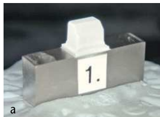
Figs. 3a y 3b. Cuerpo metálico revestido con Scanspray en el escáner 3shape y modelo CAD para los cuerpos cerámicos.
