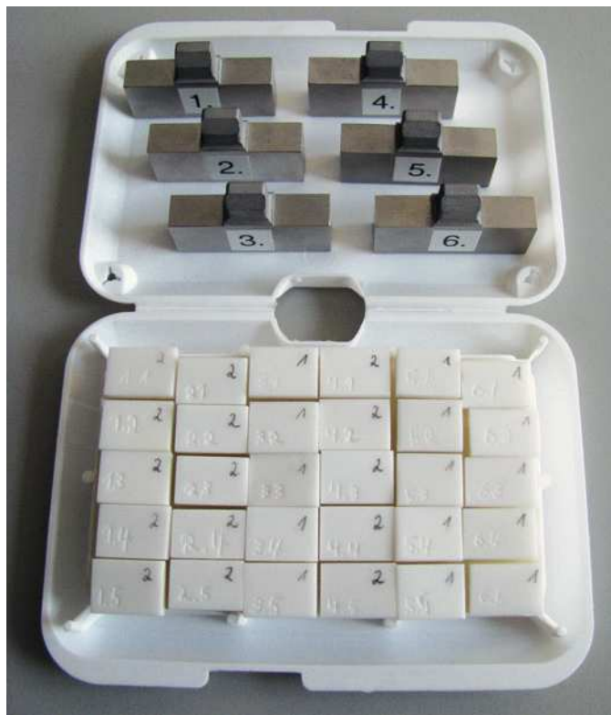
Fig. 1. Modelos de acero fino para el proceso de escaneo y fresado de las contrapiezas de Y-TZP.
