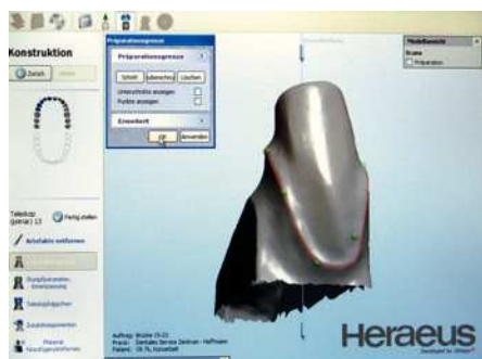
Fig. 4. Mediante el escáner 3shape (3shape, Copenhagen, Dinamarca) y el software adecuado pueden realizarse en el ordenador los diseños de las coronas telescópicas. A continuación se envían estos datos al centro de fresado de la firma Heraeus Kulzer, Hanau, Alemania.
