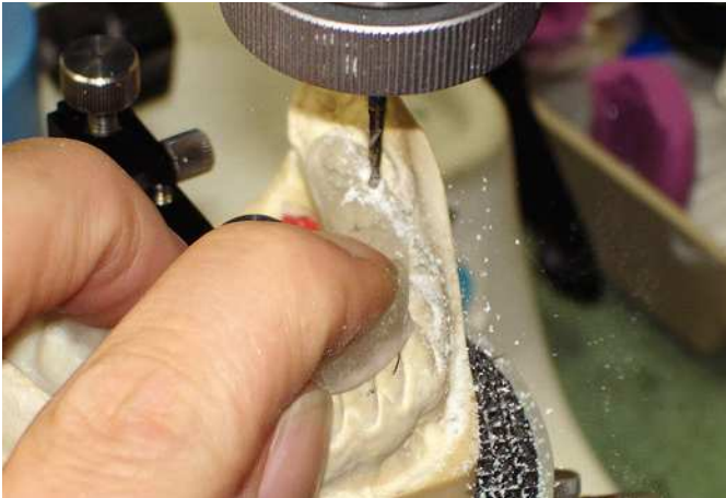
Fig. 4. Se practican perforaciones en la microfresadora como propuesta protésica.
