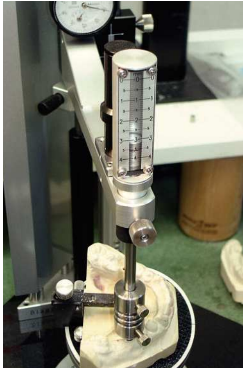
Fig. 9. Análogo de implante ajustado e insertado conforme a valores de planificación, antes de la adhesión.
