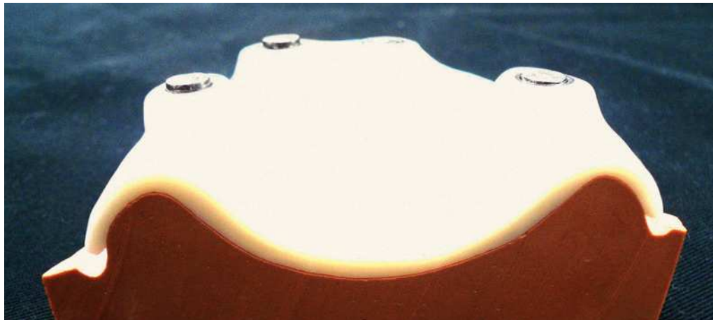
Fig. 17. El comportamiento de fisura marginal de la plantilla para implantes tras varias esterilizaciones.
