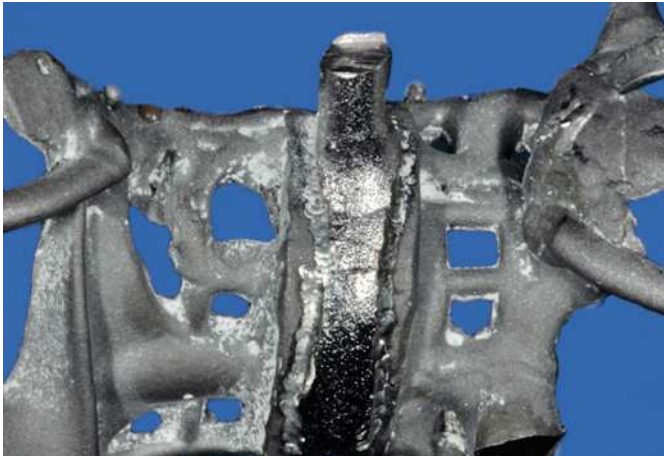
Fig. 6. Estado después de la soldadura por láser. El elemento de soldadura entrecruzado (todavía con el hito de colado unido) muestra la superficie de la costura soldada. Sin contar con que los contornos del elemento tienen que contactar con los dos segmentos del objeto colado, sus contornos son aleatorios. Los elementos conformados de igual manera pueden caerse al reparar los objetos colados o al añadir componentes.
