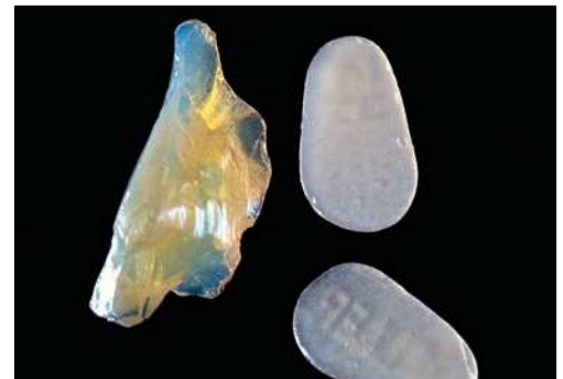
Figs. 47 y 48. La opalescencia verdadera no se puede confeccionar con materiales cerámicos artificiales. Es posible conseguir una pseudoopalescencia pigmentando con diferentes sustancias fluorescentes. Comparadas directamente con el ópalo real las masas opalescentes tienen siempre un color base blanco y cambian de azul a naranja. Las figuras muestran las posibilidades actuales de un sistema de cerámica moderna (Creation, Klema, Meiningen, Austria).
