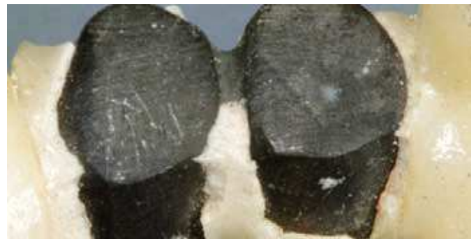
Fig. 11. Imagen de un puente objeto de reclamación en el que se han producido desconchamientos masivos. Además del modelado inadecuado y de aristas/bordes afilados, se observan huellas de abrasión. Éstas no son las estrías plateadas, sino las estructuras estriadas en las zonas de color verde-gris. Constituyen un indicio claro de que esta superficie no ha sido chorreada antes de la aplicación de la barbotina cerámica.
