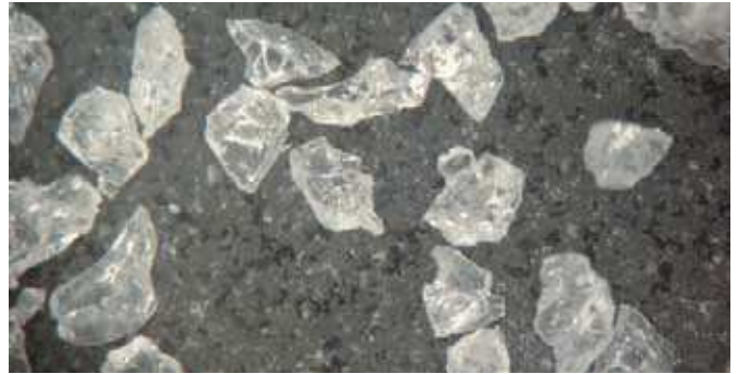
Fig. 8. Imagen de Korox 250 no utilizado (corindón con tamaño de grano 250 \mu m).
