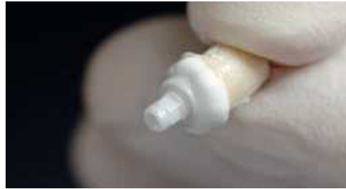
Fig. 19. Sobrante de soldadura en la pieza a unir.
