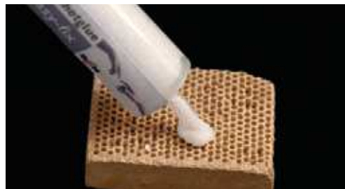
Fig. 21. El soporte de cocción se prepara con Hotbond fix, un algodón de cocción pastoso.
