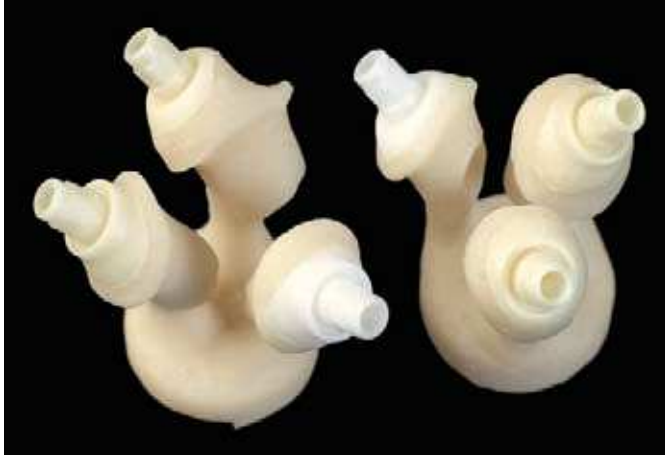
Fig. 5. Individualizaciones prensadas en pilares de cerámica de dióxido de zirconio, en estado bruto tras la compresión.
