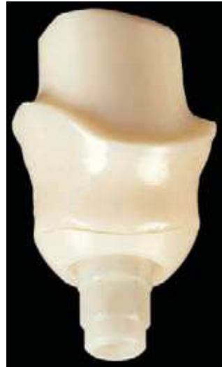
Fig. 8. El pilar cerámico soldado; debido a la transparencia de la soldadura todavía se aprecia discretamente el intersticio de soldadura.
