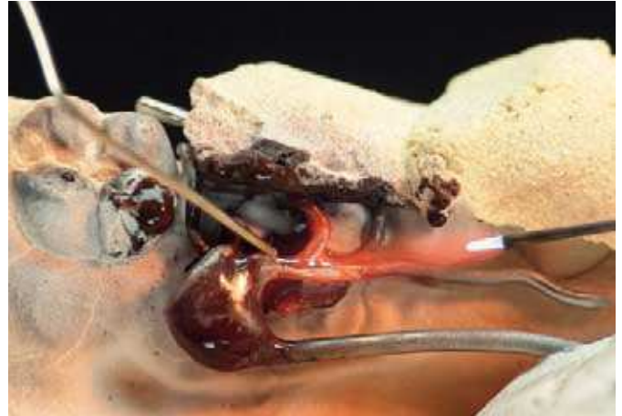
Fig. 2. Como material de unión en la soldadura indirecta suele utilizarse una aleación metálica fácilmente fundible, el denominado metal de aportación.
