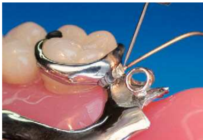
Fig. 13. La soldadura por impulsos con chorro de plasma mediante phaser posibilita una soldadura libremente móvil y extremadamente precisa.
