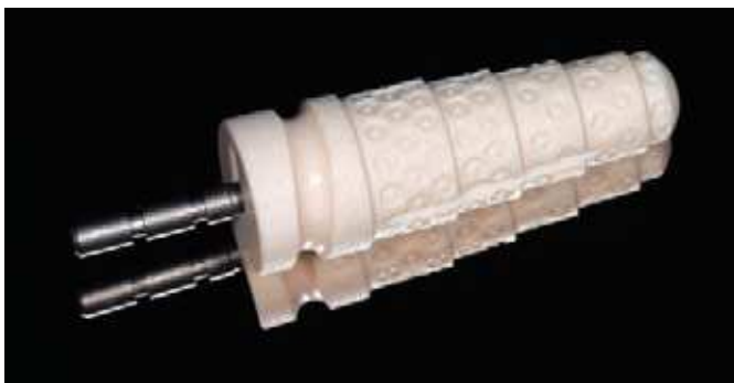
Fig. 4. El implante inmediato de Tübingen realizado en cerámica de óxido de aluminio. El implante tiene una estructura escalonada, a fin de mantener reducidas mediante las superficies de transmisión los picos de fuerza durante la aplicación de las fuerzas masticatorias. La maximización de la superficie se consigue mediante lagunas. En el punto de paso del implante se ha practicado un surco abrillantado. En él se debe acomodar la mucosa en forma de manguito. De este modo, la acumulación de epitelio debería estar protegida de forma óptima contra cargas mecánicas 28 .
