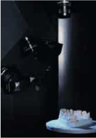
Fig. 1. Estructura de un método de medición activa (hiScan, Hint-ELs GmbH).
