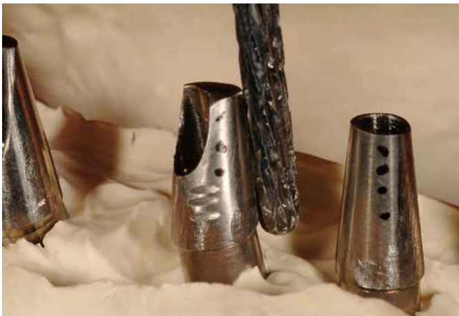
Fig. 13. Retoques de los pilares en la fresadora.
