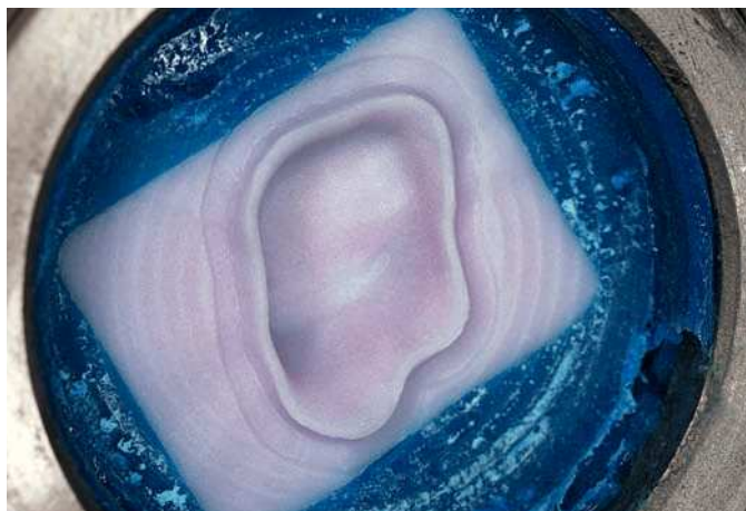
Fig. 8. Las estructuras se confeccionan en un proceso de fresado a partir de bloques cerámicos (Everest, KaVo, Biberach, Alemania).
