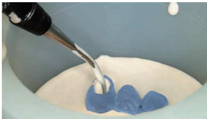
Fig. 26. Puesta en recubrimiento sin burbujas utilizando PressVEST Speed (Ivoclar Vivadent).
