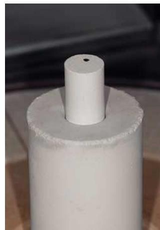
Fig. 11. Antes del proceso de inyección, la mufla con el punzón insertado.
