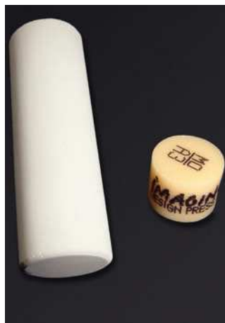
Fig. 10. El punzón de inyección y pellet de inyección preparados.
