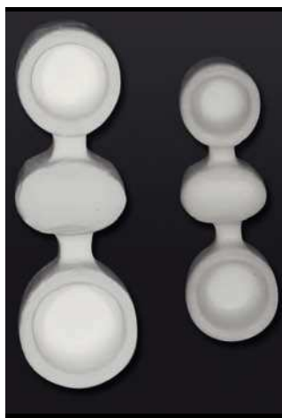
Fig. 7. Puentes de dióxido de zirconio, a la izquierda en estado blanco, a la derecha sinterizados a la máxima densidad.
