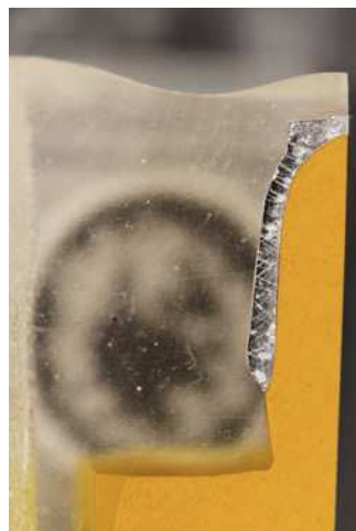
Fig. 4. Cuarto de corona preparado para la medición, sobre un muñón de resina de modelado, revestido en material autopulimerizable transparente.
