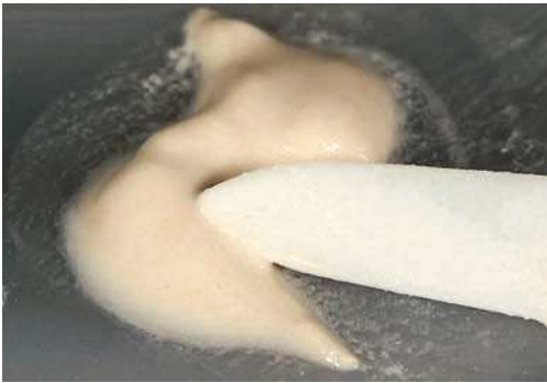
Fig. 16. Al mezclar Opaque Liner y las masas de estratificación VINTAGE se utiliza VINTAGE Modelling Liquid. El mezclado dura algo más de lo acostumbrado.
