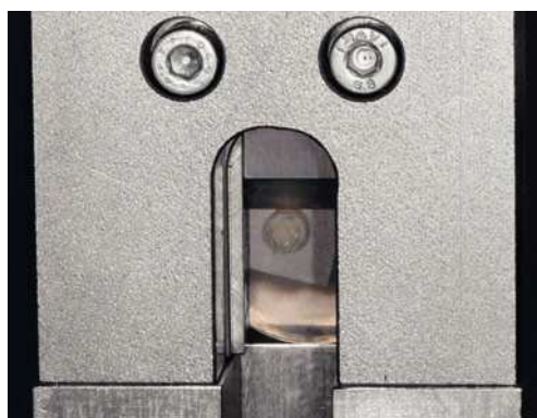
Fig. 7. El cuerpo de ensayo, fijado en el dispositivo de presión.
