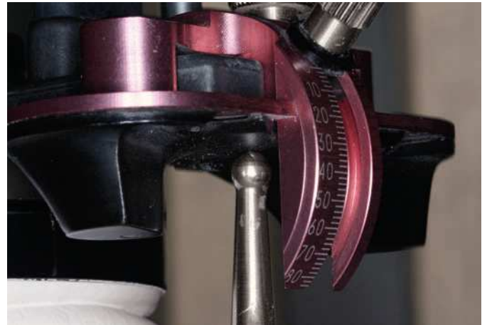
Fig. 14. Se aplica el perno de apoyo sobre el plato incisal.
