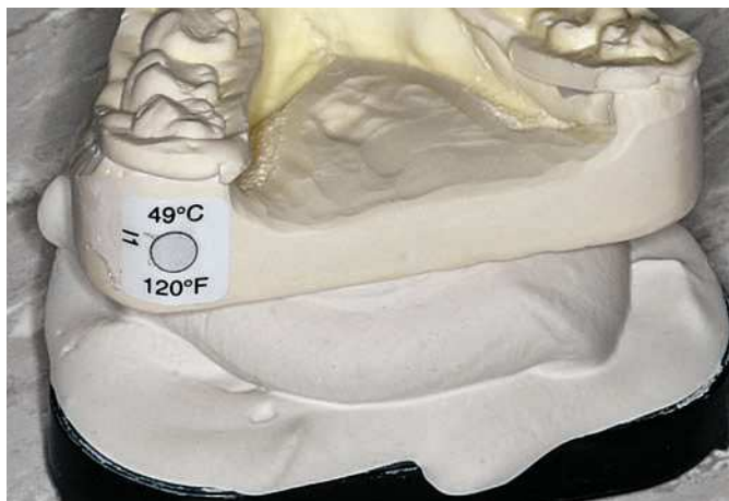
Fig. 7. El indicador de temperatura es gris inicialmente.
