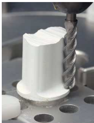
Fig. 26. Mecanizado de desbaste de la superficie exterior.
