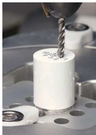
Fig. 25. El inicio del proceso de fresado en la pieza bruta Preform.
