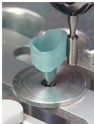
Fig. 28. Exploración del modelado mediante el explorador especial.
