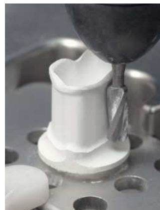
Fig. 29. El mecanizado de alisado de la superficie funcional mediante una fresa especial.
