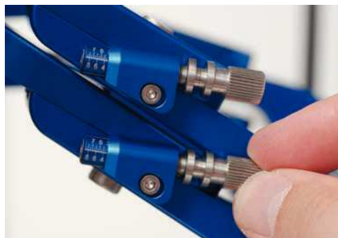
Fig. 4. El movimiento vertical del pantógrafo Ceramill Multi-x sin movimiento circular.
