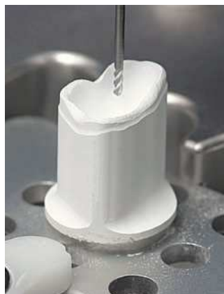
Fig. 27. Mecanizado de la superficie interior de la corona.
