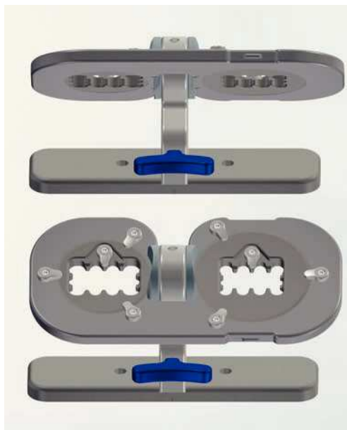
Fig. 6. Las posibilidades de giro e inclinación de la mesa de trabajo Ceramill Base.
