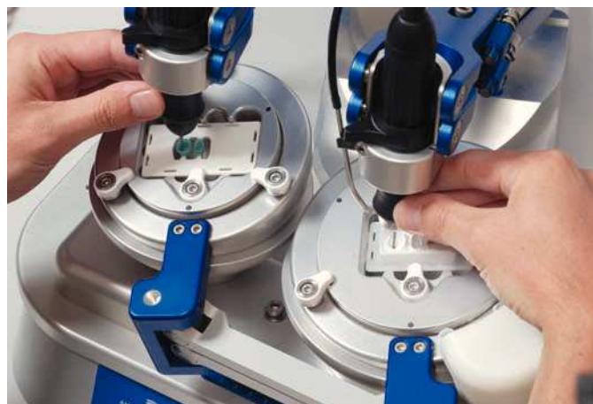
Fig. 8. Mecanizado sencillo de zonas retentivas mediante la mesa de casquillos esféricos Ceramill Multi-x.
