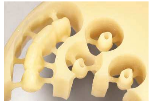
Fig. 10 Los pilares provisionales y el puente provisional se fresaron a partir del material de resina ZENO® PMMA A3.
