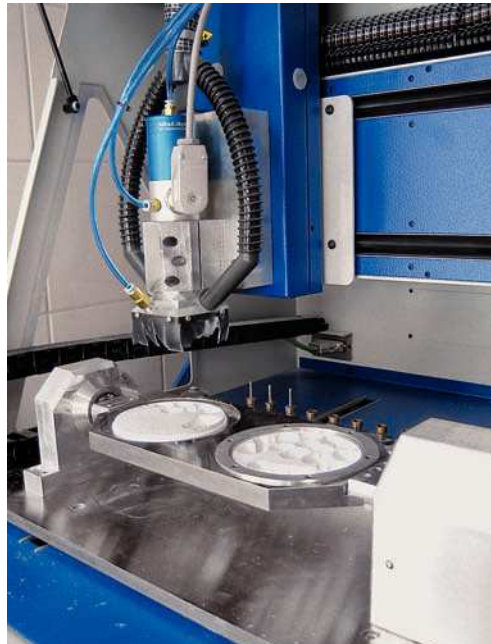
Fig. 20. Es posible cargar la unidad de producción con dos discos de material al mismo tiempo, a fin de lograr unas tasas de producción elevadas.
