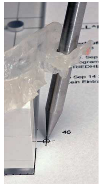
Fig. 8. Unas espigas de guía especiales permiten el control durante el ajuste manual del posicionador, para determinar si se han polimerizado las ayudas de guía conforme a los valores.
