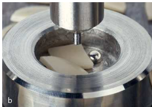
Figs. 5a y 5b. Diseño del ensayo de flexión biaxial: a) antes de la medición, el cuerpo de ensayo está intacto; b) tras la medición, el cuerpo de ensayo está roto.
